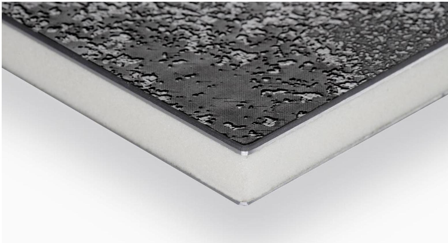
Panneau en plastique avec couche supérieure en HPL d'une épaisseur de 11 mm adapté aux murs dans les couloirs de nouvelle construction ou de rénovation, lorsqu'il est installé 3 mm fourni avec de la colle !! Épaisseur totale 14 mm (surface inégale) ou dans les salles de douche (hydrofuge), se pose par collage;
